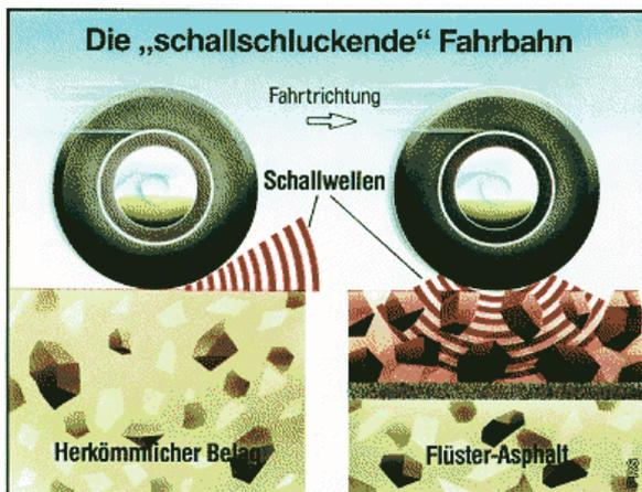
Abb. 3: Die „schallschluckende“ Fahrbahn. Links: herkömmlicher Belag, rechts: offen-poriger Belag
